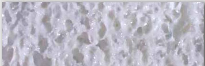
Un material "amante del agua". Los grouts hidrofílicos prosperan con el agua y la buscan dentro de la grieta principal y sus grietas tributarias. Absorben y reemplazan el agua del sustrato mientras curan.
