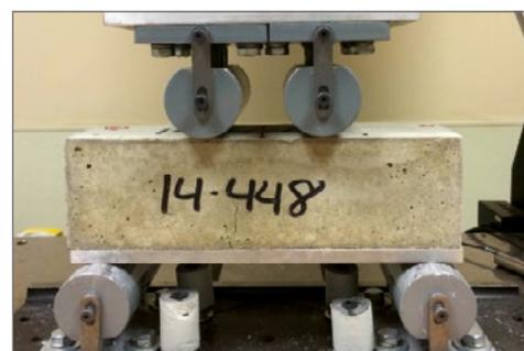
desviación) en la curva de carga-deflexión posterior a la grieta. Un valor mínimo de ARS se puede determinar de una especificación cuando las fibras macro se reemplazan las barras de refuerzo de acero/malla. El valor de ARS de C1399 es normalmente ligeramente superior que el  $f_{e,3}$ , obtenido a partir de C1609.
