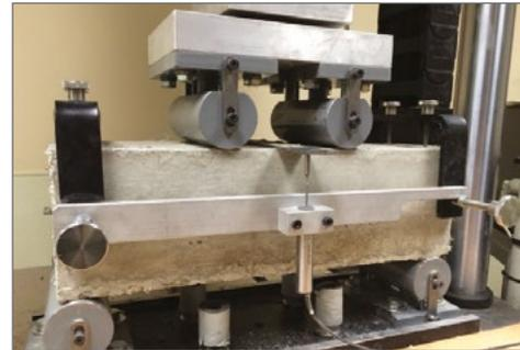
ASTM C1399 – 10: Método Estándar de Prueba para Obtener Resistencia Residual Promedio de Concreto Reforzado con Fibras
